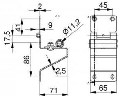
Bisagra lateral Portarodillo silencioso para paneles Thyssenkrup, Hoesch, Tecnopan & Kingspan con protección de dedos.
