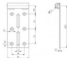
Portarodillo superior para sistema LHF para rodillos de 11mm.
