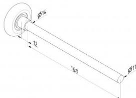
Rueda de 46 mm de diámetro con eje largo, diseñada para puertas de más de 5 metros con bisagras dobles. Soporta 35 kg para 750.000 ciclos. Uso residencial e industrial..
