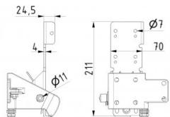
Seguridad de cable industrial. Para rodillos de 11 mm. Peso máx. puerta: 750kg. Certificado TÜV Tor/Fv 6/102. Instalación del microinterruptor con art. 25446A. Máx. cable Ø: 6mm.
