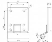
Placa base con 18mm de offset para nuestros sistemas de guías HOME-X y HOME-R. Para rodillos de 11mm.
