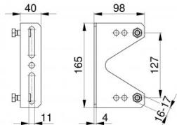
Soporte para seguridades de muelle industriales 25449 y 25549. Offsets: 111mm, 127mm o 152mm. Incluye elementos de fijación.
