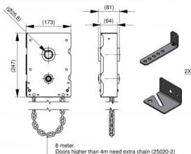
Elevador de cadena transmisión directa montado al eje (25,4mm). Reducción 4:1. max 700kg. Max. desequilibrio 5%. Incluye: soporte cadena, 2 anillos, soporte pared, chaveta, 1 tornillo, 8 mtr de cadena.
