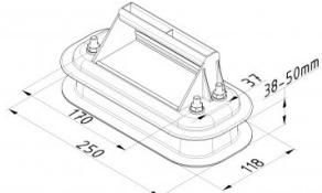
Empuñadura de plástico para paneles de grosor 38-50 mm. 2 piezas.
