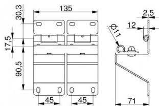
Bisagra lateraldoble con portarodillo para paneles standard sin protección de dedos. Para rodillos de 11mm 25011-E, 25068, 25156 & 25157 y cantonera doble ancho perforada 80010-L & 80011-L Aplicación: industrial. Material: Acero zincado.
