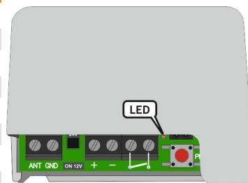
Los destellos son cortos (0.5 seg). Después el indicador se vuelve a encender durante 5 segundos más y se apaga, indicando que el arranque ha finalizado.
