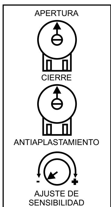
Este ajuste no modifica la fuerza del motor, sino que, controla el esfuerzo realizado por éste, durante el movimiento de la puerta, detectando cualquier exceso que sobrepase el límite prefijado.
