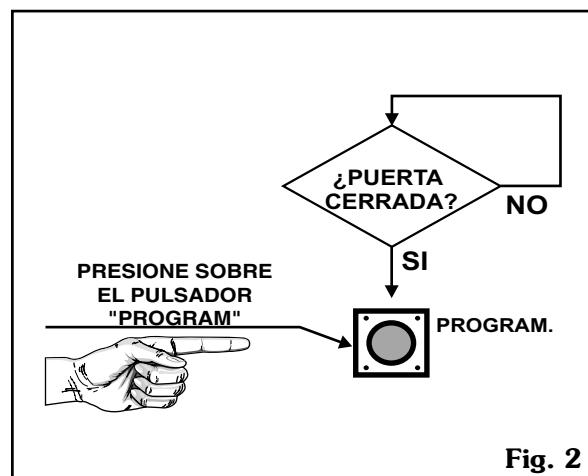
**NOTA:** Para entrar en programación, necesitaremos, **que la puerta esté cerrada, es decir, que el final de carrera de cerrar esté activado** y pulsar sobre la tecla **PROGRAM**, figura 2, se encenderá de forma intermitente los leds del indicador de **FUNCIÓN** 3 veces. Si después de pulsar esta tecla, no realizamos ninguna operación en 30 segundos, el Cuadro saldrá del modo programación, encendiéndose de forma intermitente, los leds del Indicador de **FUNCIÓN**, 5 veces.
