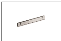
GA551 Cremallera en acero 30x12x1000 zincado, módulo 4, completa con distanciadores y tornillos.
